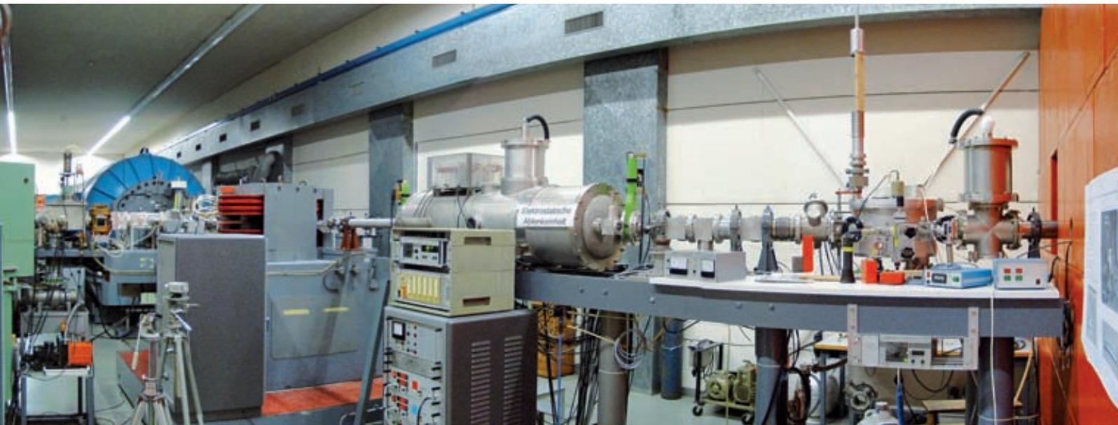
Mit dem Tandem-Beschleuniger an der ETH Zürich werden Strahlenschädigungen an Werkstoffen erzeugt, um Erkenntnisse für zukünftige Nuklearanlagen zu gewinnen. Nach der Bestrahlung werden die Zusammenhänge zwischen Werkstoffeigenschaften und Gefüge am PSI erforscht.
