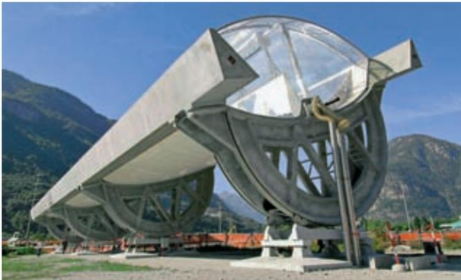
Der dritte in Betrieb genommene Prototyp im Werkareal der AirLight Energy in Biasca. Der konzentrierende Kollektor hat einen linearen Aufbau und beruht auf einem ganz neuen Konzept mit flexiblem, pneumatischem Spiegel. Die Membranen sind an ihrem Rand durch einen einfachen Rahmen aus vorgefertigtem Spannbeton befestigt.
