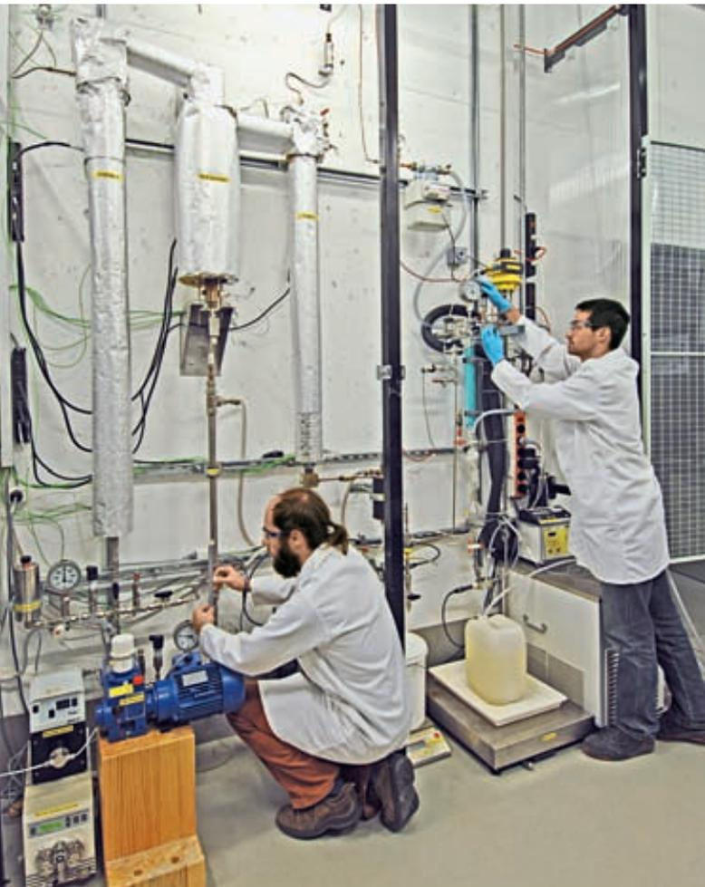
Am Paul Scherrer Institut in Villigen wird die katalytische hydrothermale Vergasung von Biomasse in einer kontinuierlichen Laboranlage mit einem Durchsatz von 1 kg/h untersucht. Typische Betriebsbedingungen sind 400 °C und 30 MPa.
