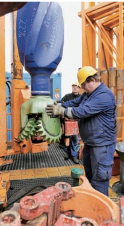
Au cours de l'hiver 2009/10, les services industriels de la ville de Zurich (ewz) ont effectué des forages jusqu'à une profondeur d'environ 2700 m en vue d'étudier le sous-sol zurichois et, idéalement, d'exploiter des nappes d'eau chaude. Le projet de forage a fourni une foule de données géologiques, sans toutefois déboucher sur la découverte de nappes importantes. Les données sont maintenant utilisées pour mieux évaluer le potentiel géothermique de la région de Zurich.
