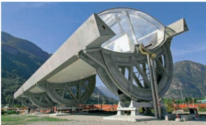
Troisième prototype mis en fonction sur le site de l'entreprise AirLight Energy à Biasca. Le collecteur à concentration a une configuration linéaire et exploite un concept tout nouveau basé sur un miroir flexible pneumatique. Les membranes sont fixées sur leur bord par un simple cadre en béton préfabriqué et précontraint.
