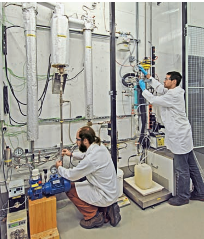
I ricercatori del Paul Scherrer Institut (PSI) di Villigen stanno sperimentando in laboratorio la gassificazione idrotermale di biomassa. Gli esperimenti vengono condotti in un impianto continuo con un output netto di 1 kg/h e condizioni di esercizio che si situano in media attorno a 400 °C e 30 MPa.
